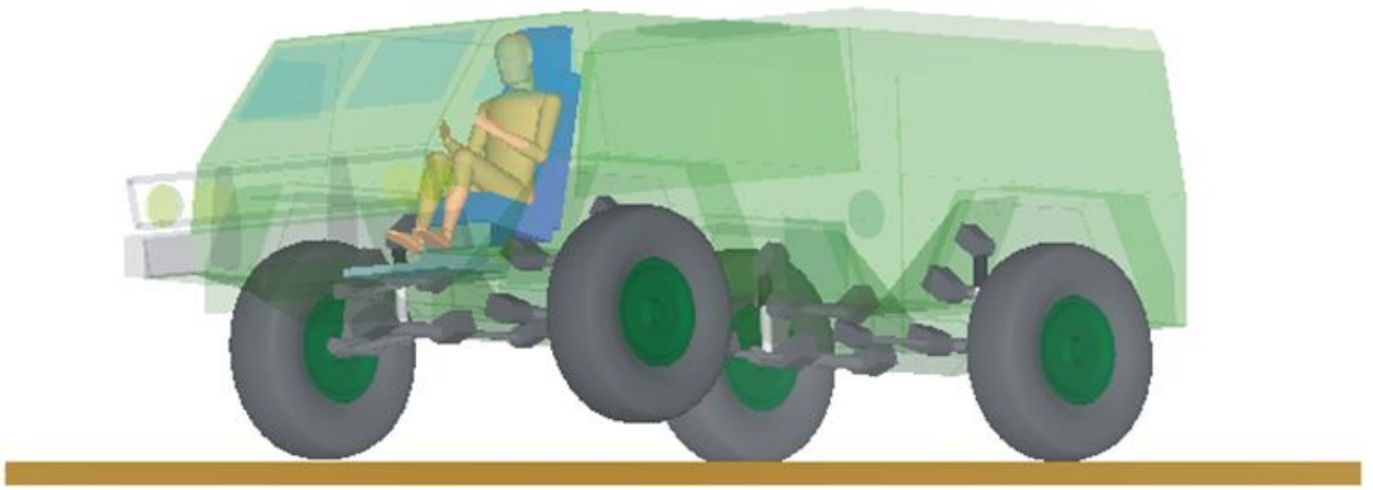
Рис. 5. Моделирование подрыва на фугасном боеприпасе
