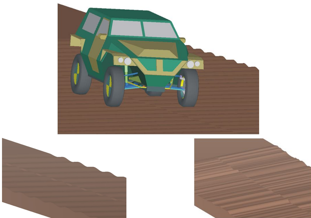
Рис. 3. Моделирование испытаний на плавность хода при заданном и случайном профиле дороги
